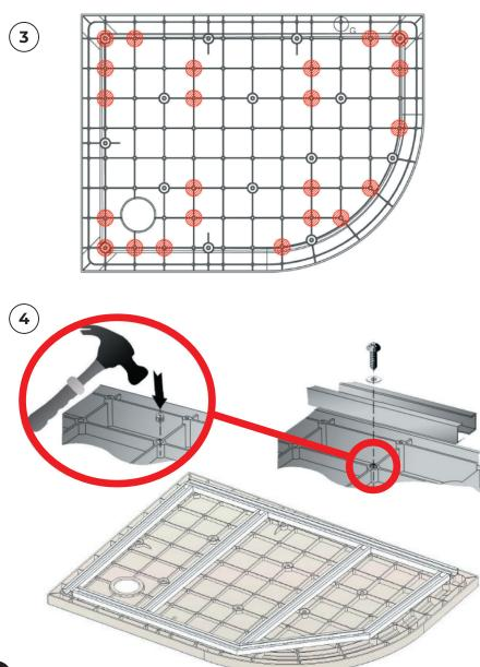
Переверните поддон, используя картонную упаковку в качестве защитного коврика, и вставьте ножки в указанные места. Закрутите зажимы для панелей со стороны, на которой они будут крепиться.
