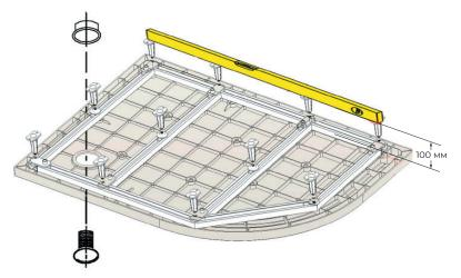
**8** Установите поддон на место и отрегулируйте все внутренние ножки для его стабилизации. Подключите слив и проверьте его работоспособность, пролив его водой
